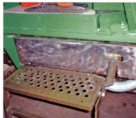
Fast alle Bleche mussten geschweißt, viele aber auch nachgebaut werden. Durch die dicke Dachhaut hatte es der Rost nicht „geschafft“
