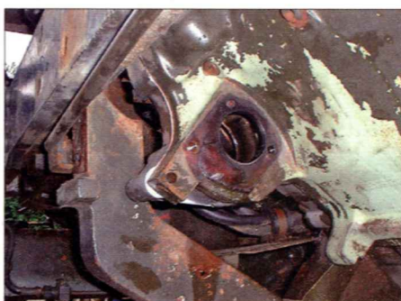
Die Hydraulikpumpe leckte nach Innen, ihr Öl vermischte sich mit dem Motoröl. Dies war der schwerwiegendste technische Mangel
