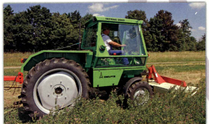
Vorne Schneiden, hinten einladen – zwei Fliegen mit einer Klappe: So sah es das Intrac-System zumindest vor. Die dritte Anbaufläche war über der Hinterachse
