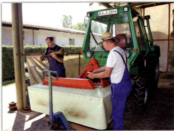
Den Fahr-Frontkreiselmäher KM22 F hat Hartwig Heil ebenfalls überholt. Das Gerät entstand in den Siebzigern im Rahmen des Intrac-Systems 2000
