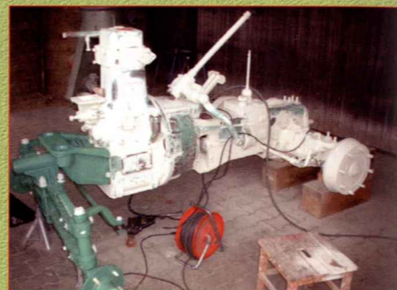
▲ Falsch beraten: Lack und Grundierung vertrugen sich nicht – also musste die Anstrich-Prozedur wiederholt werden.
