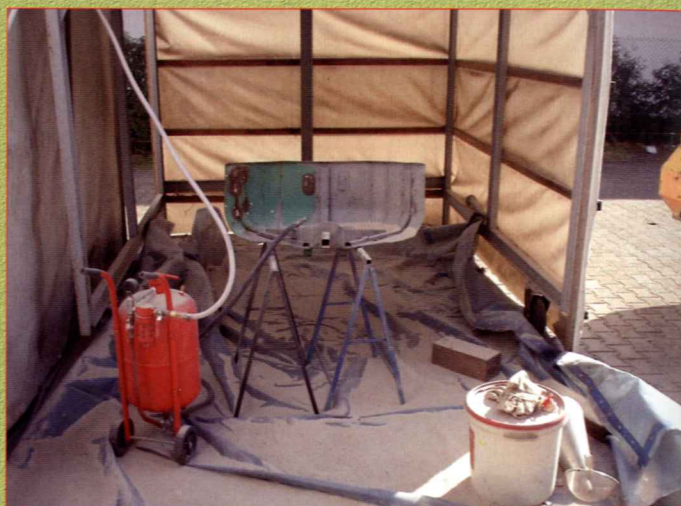
▲ Ein Hauch von Sahara: Das Sandstrahlen der Blechteile erledigte Hartwig Heil selbst.
